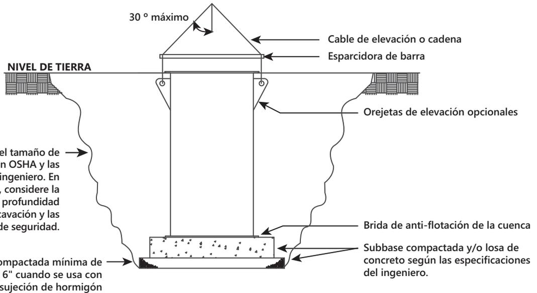
La pendiente y el tamaño de excavación según OSHA y las especificaciones del ingeniero. En ausencia de estos, considere la condición del suelo, la profundidad de la excavación y las consideraciones de seguridad.
