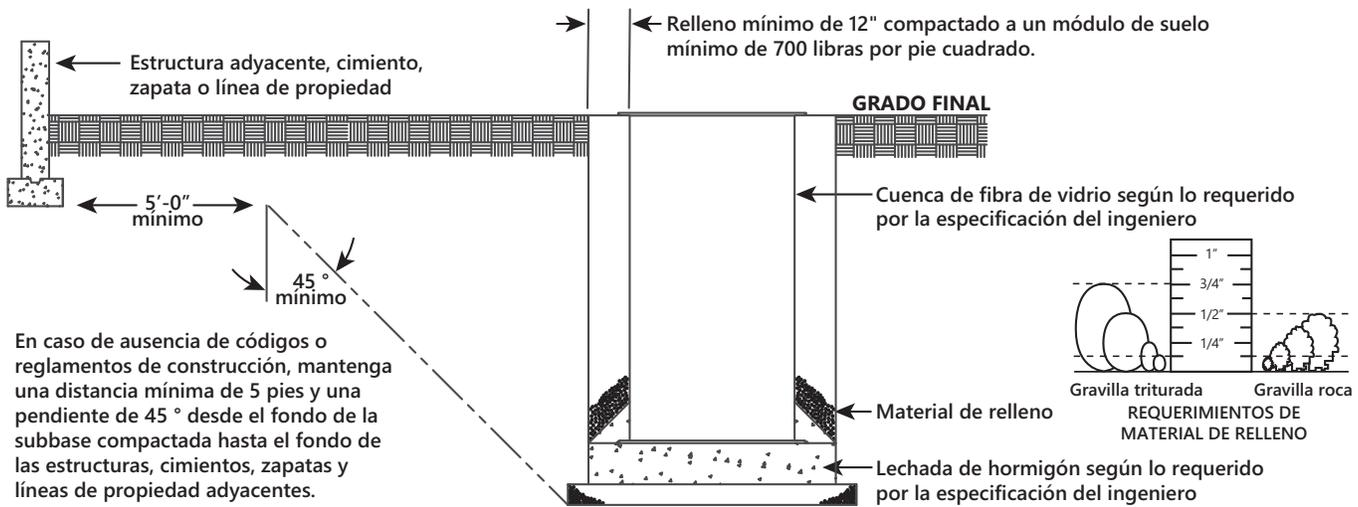
En caso de ausencia de códigos o reglamentos de construcción, mantenga una distancia mínima de 5 pies y una pendiente de 45° desde el fondo de la subbase compactada hasta el fondo de las estructuras, cimientos, zapatas y líneas de propiedad adyacentes.
